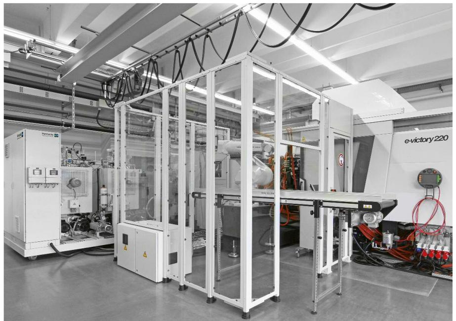
Produktionszelle mit einer Spritzgussanlage und integrierter STREAMLINE-Dosiermaschine zur Herstellung von clearmelt®-Bauteilen
